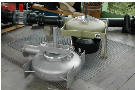
Figur 5 Testing av GRP Virvelkammer hos UFT. Nederst i bildet sees et tilsvarende virvelkammer i stål utførelse
