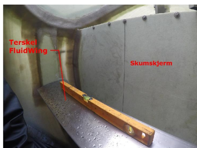
Figur 4 Overløp med kalibrert terskel av typen FluidWing
