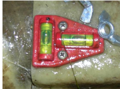
Figur 2 Sjekk av korrekt orientering - begge libeller spiller
