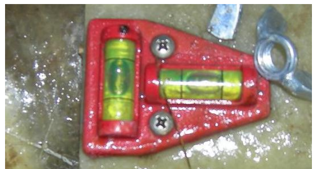
Figur 3 Sjekk av korrekt orientering - begge libellene spiller
