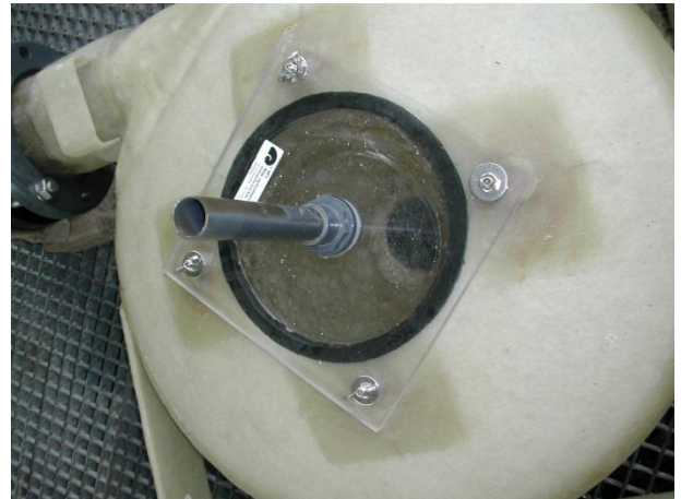
Figur 10 FluidCon SUt med standard inspeksjonsåpning
