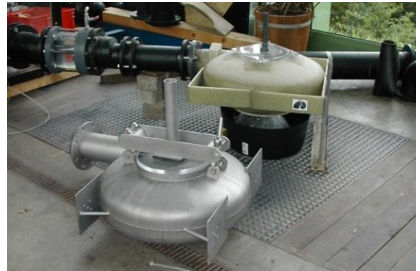
Figur 5 Testing av GRP Virvelkammer hos UFT. Nederst i bildet sees et tilsvarende virvelkammer i stål utførelse
