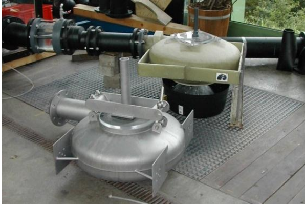
Figur 3 Testing av GRP Virvelkammer hos UFT. Nederst i bildet sees et tilsvarende virvelkammer i stål utførelse
