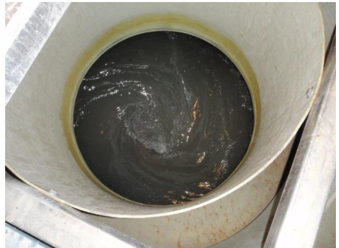
Figur 12 FluidSep i overløpsdrift (virvel i senter av skumskjerm-ring).
