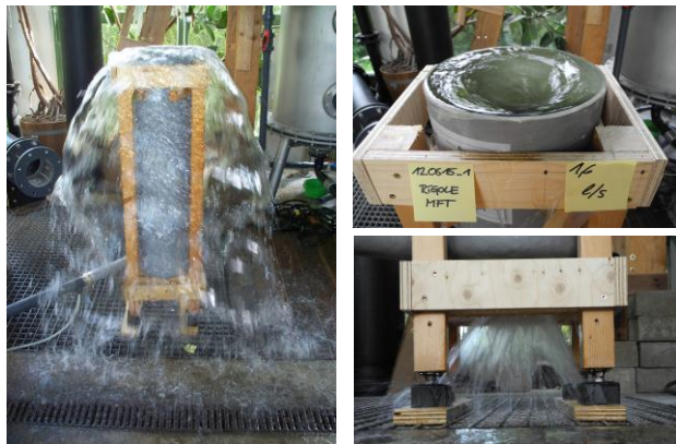
Figur 4 Testing MFTs FluidVortex-R i GRP i UFTs laboratorium i Tyskland. T.v. Nødderløpet i funksjon. Ø.t.h dimensjonerende vannnivå. N.t.v utløpsstråle.
