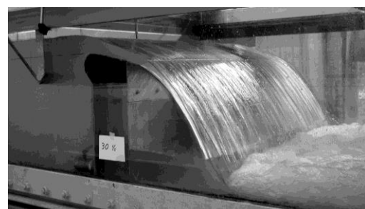
Figur 3 Hydraulisk testing av FluidWing på laboratorium i Stuttgart
