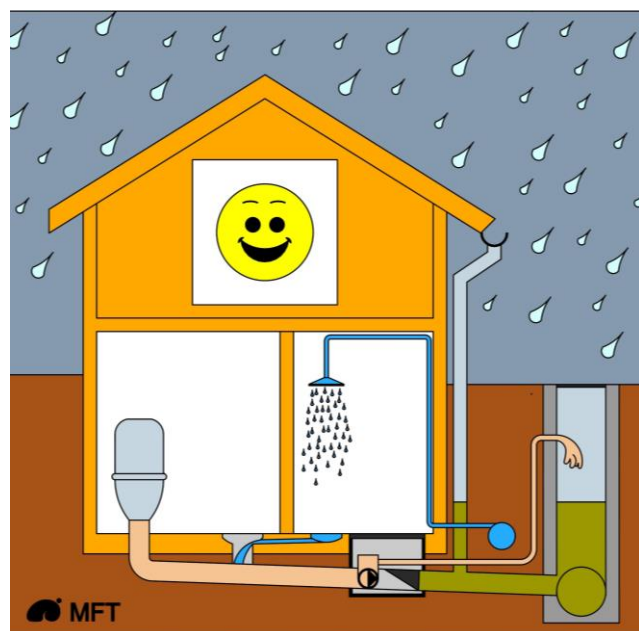
Tilbakeslagsventil og pumpe
