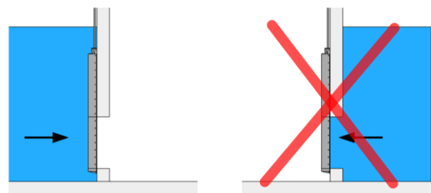
Stengeluke dimensjonert for 1-sidig trykk sperretrykk tillates kun fra en side
