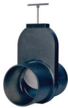
Modell: GV Dimensjon: DN100-300 Maks sperretrykk: 2-4 bar, 1-sidet Betjening: trekkstang Medium: slamholdig vann Utførelse: PE, 304 - rustfritt
